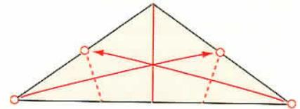
**6** Voici le pentamodule ; 2 poches permettent de recevoir des triangles d'autres modules pour un assemblage.
